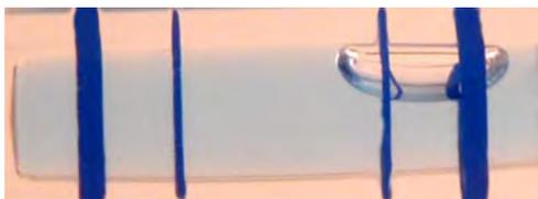
Dieses Bild zeigt einen unebenen Zustand. Wenn die Maschine eben ist, befindet sich die Blase genau in der Mitte zwischen den beiden Linienpaaren.
