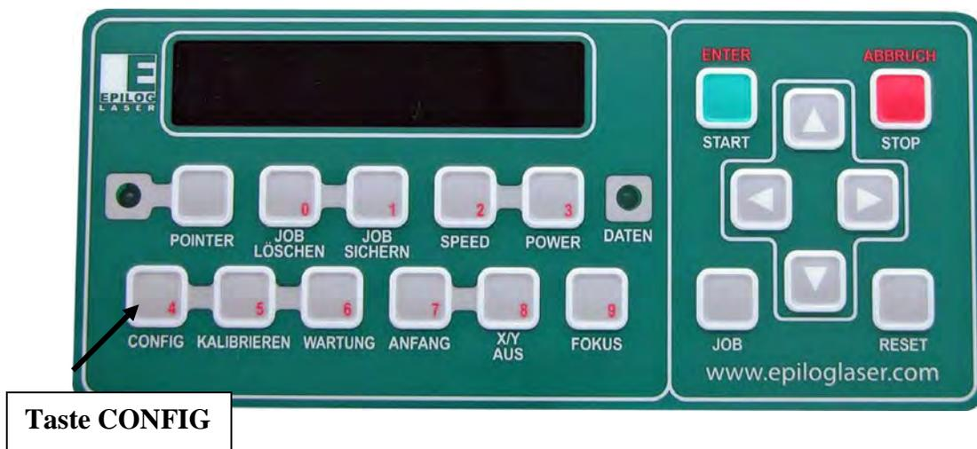
Drücken Sie zum Aufrufen dieser Einstellungen die Taste **CONFIG** und anschließend die Aufwärts-/Abwärts-Pfeiltaste, um einen Bildlauf zum gewünschten Feld durchzuführen.
