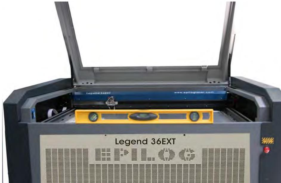
6. Achten Sie auf die Mittenanzeige der Wasserwaage. Die mittlere Anzeigeblase lässt die Ebenheit der Maschine erkennen.
