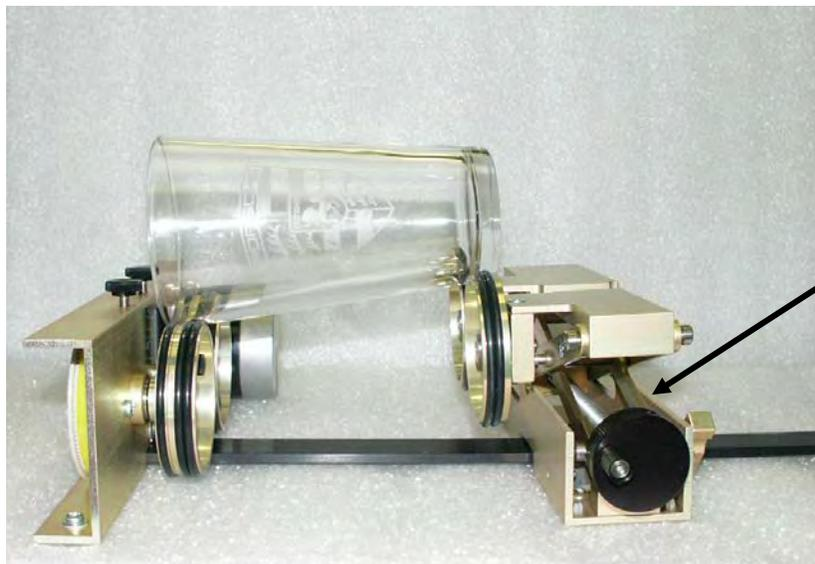
Heben Sie die rechte Seite des zu gravierenden Objekts mit der Hebevorrichtung am Rotationszubehör an, damit die Gravierfläche horizontal ist.
