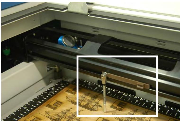
Gabarit de mise au point / système de ressort.
