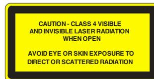
5. Etiquette de Sécurité pour Carénage de Protection à interverrouillage annulable Label. Cette étiquette se trouve sur la porte supérieure de la machine.
