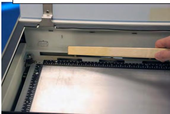
Nettoyez les ouvertures d'aspiration depuis l'intérieur de la machine. Le mieux est d'utiliser une brosse souple en matière plastique ou métallique pouvant pénétrer dans les ouvertures.
