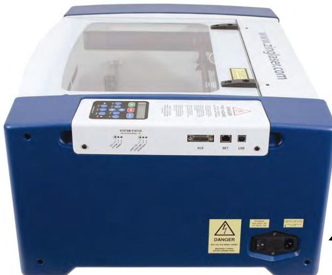
Zing Buchse für Stromkabel
