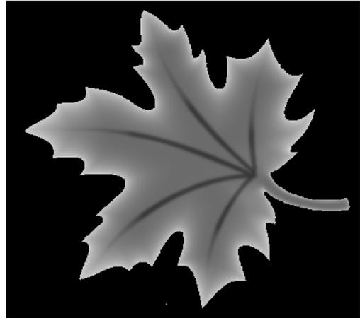
Bei diesem Bild ist die Gravur an den Rändern am tiefsten und in der Mitte weniger tief.
