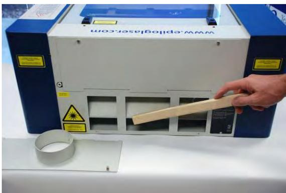
Säubern Sie die Kammer mit einer flexiblen Plastik- oder Drahtbürste, mit denen man auch das Innere reinigen kann, man kann auch hier ein Pinsel benutzen.
