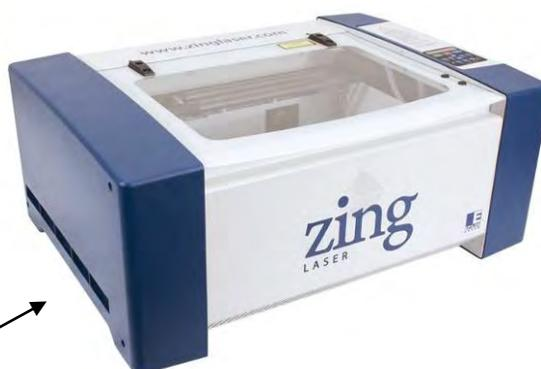
Das Kühlgebläse des Lasers und die Öffnungen befinden sich entlang der unteren linken Seite Ihrer Maschine. Blockieren Sie diese Seite des Lasersystems auf keinen Fall, indem Sie das Gerät gegen die Wand oder ein anderes Hindernis stellen.
