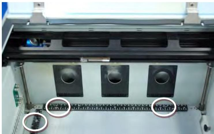
Hay 3 pines de ajuste en la parte inferior de la malla de corte.
